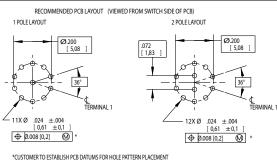
TERMINAL VIEW 2 POLE COMMON 2 TERMINAL 1 0 0 .072 ±.005 [ 1,83 ±0,12 COMMON - 12X Ø .015 +.003 -.002 0,38 +0,07 -0,05
