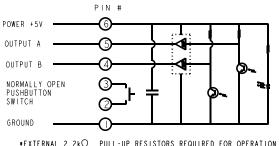
\*EXTERNAL 2.2 k $\Omega$  PULL-UP RESISTORS REQUIRED FOR OPERATION
